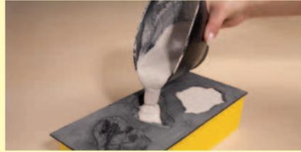
Der enthaltene Gussrahmen ermöglicht das ebene Einfüllen der NOCH PROFI-Gießmasse.
