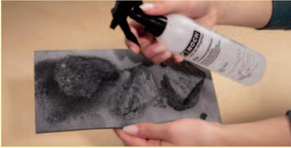
Die Fels-Gussform wird mit einem Trennmittel aus Wasser und Spülmittel eingesprüht.
